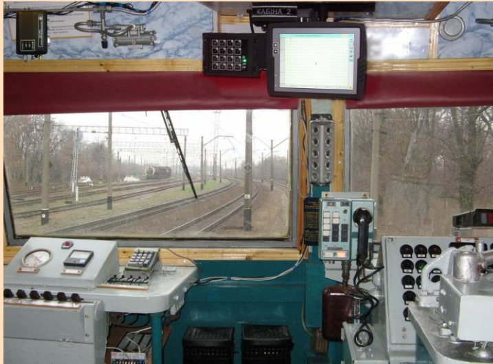
Размещение оборудования в кабине электровоза серии ВЛ-11
