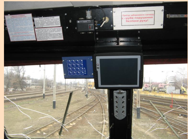
Размещение оборудования в кабине электровоза серии ЧС-7
